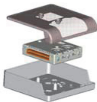
Рисунок 1 Установка в корпус
