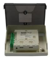
Монтажный бокс M200E-SMB предназначен для настенной установки адресных модулей серии 200AP. Бокс имеет прозрачную крышку. Индикаторы и переключатели адреса адресного модуля видны через крышку. На основании бокса предусмотрены места для ввода кабеля. Рядом с посадочным местом модуля расположена клемма для подключения экрана кабеля. Основание монтажного бокса прикрепляется к поверхности, затем модуль и крышка привинчиваются к основанию с помощью двух винтов.
